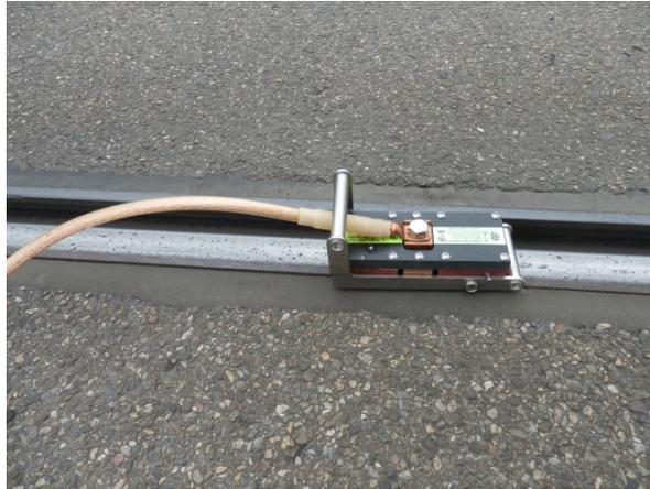
**Abb. 4 Bahnerdung für mobile Geräte**
